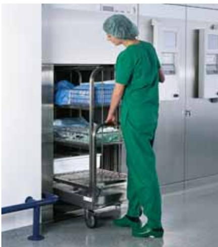
**Inserimento nell'autoclave di un carrello di trasferimento con struttura scorrevole.**
