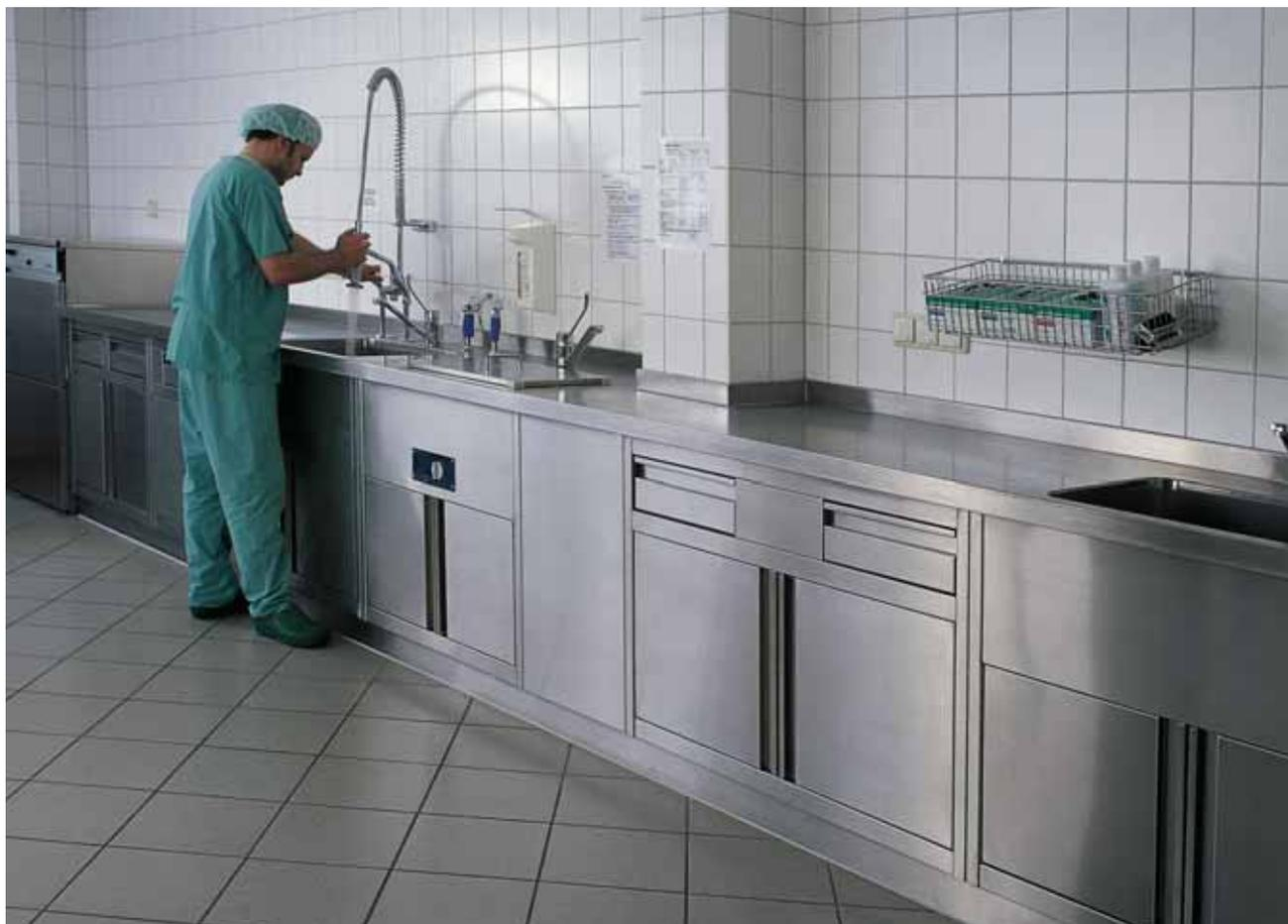
HUPFER® ha sviluppato banchi per il lavaggio e la disinfezione dei prodotti contaminati. Le basi di lavoro sono interamente in acciaio inox 18/10 con bordature anti goccia. Sul retro delle superfici di lavoro sono posti dei para schizzi. L'altezza standard di questi banchi è 900 mm ma è possibile produrli anche in altezze diverse. Nel catalogo appaiono lavelli di diverse dimensioni, perché le dimensioni saranno concordate con il cliente in base alle diverse necessità.
