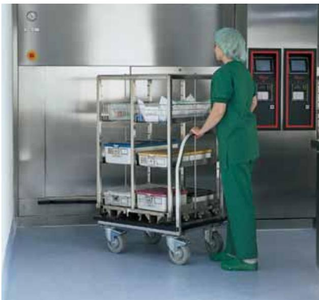
**Inserimento nell'autoclave dotata di piattaforma d'accesso**
