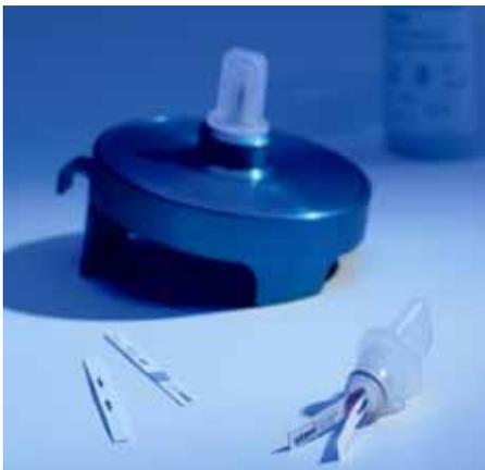
Il dispositivo è in alluminio anodizzato munito di un piccolo foro sul bordo esterno dal quale penetra il vapore.
